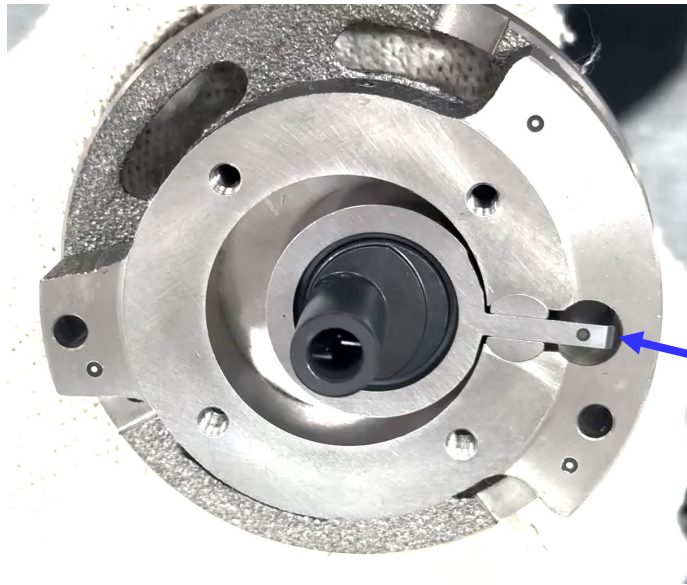
ダイキン製スイング式圧縮機の機構
